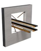
Schottmasse so einbringen, dass ein fester, dichter Anschluss zum Bauteil entsteht. Zwischenräume und Zwickelhohlräume vollständig ausfüllen.
